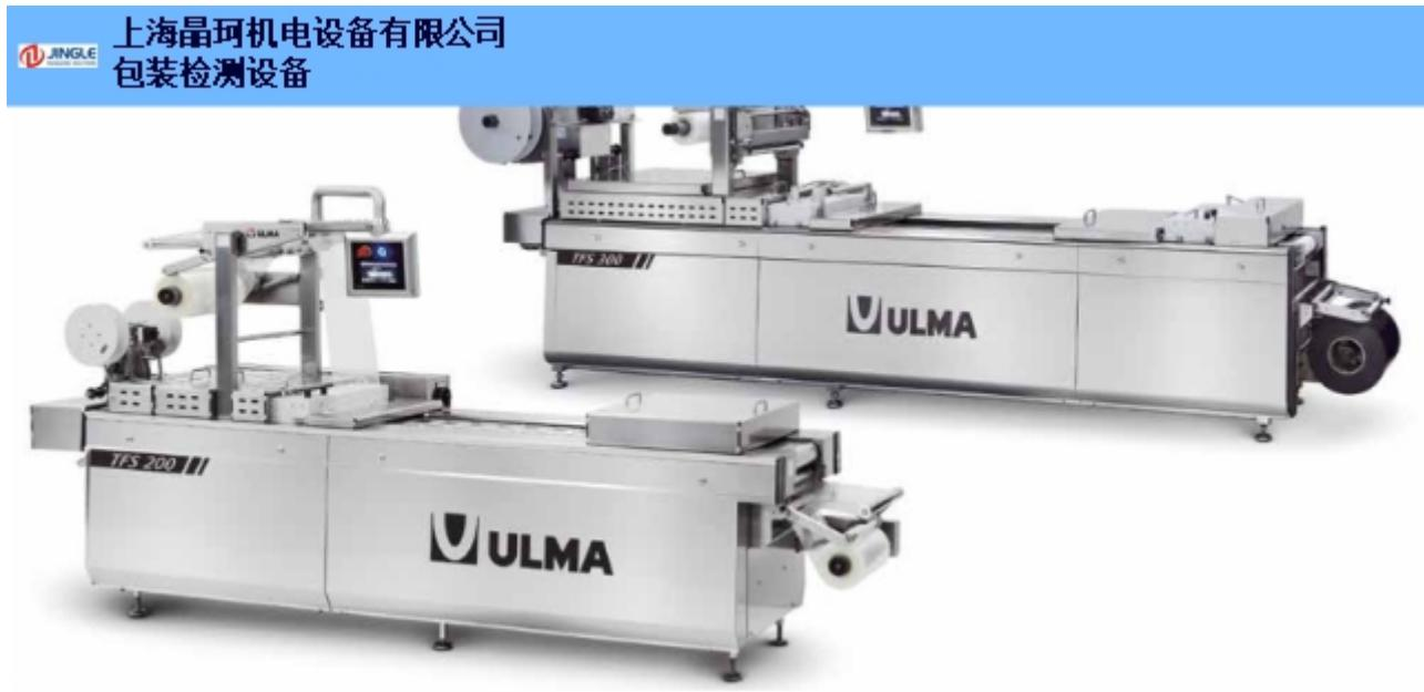
拉伸膜包装机以塑料或塑料铝箔薄膜为包装材料，对生鲜肉制品、熟食、固体、粮食、果品、酱菜、果脯、医用产品、药材、电子元件、仪器、稀有金属等进行真空包装，经过包装的物品可以防止氧化、霉变、虫蛀、腐烂、受潮，延长保质保鲜期限。
