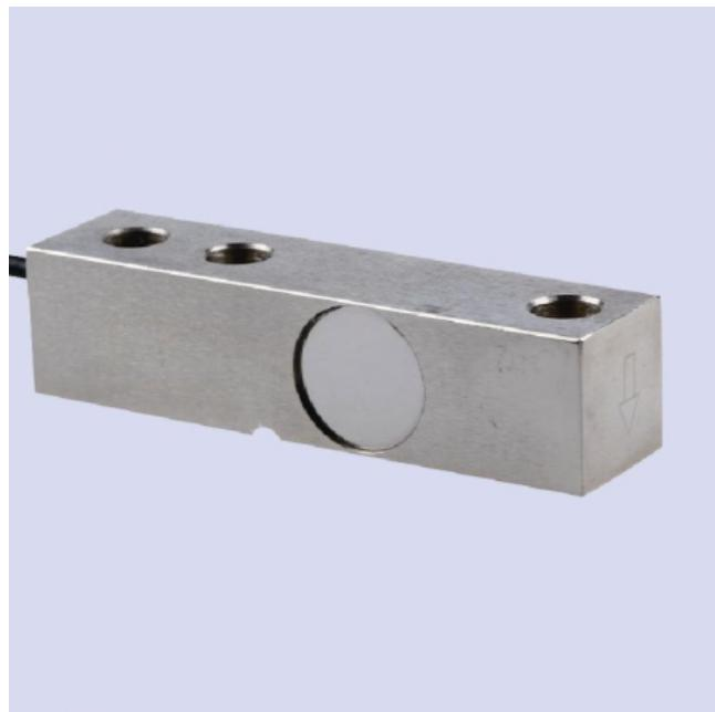
测力传感器由一个或多个能在受力后产生形变的弹性体，和能感应这个形变量的电阻应变片组成的电桥电路(如惠斯登电桥)，以及能把电阻应变片固定粘贴在弹性体上并能传导应变量的粘合剂和保护电子电路的密封胶等三大部分组成测力传感器。公司主要生产铝合金称重传感器，轮辐式称重传感器，平行梁称重传感器，悬臂梁称重传感器，柱式称重传感器，波纹管式称重传感器，轴承座称重传感器，微型称重传感器，不锈钢称重传感器，膜盒称重传感器，脚踏板称重传感器，拉力传感器/S型拉力传感器，板环拉力传感器，柱式拉力传感器，扭力传感器，钢丝绳张力传感器，三滑轮张力传感器，二维力传感器，三维力传感器，轴销传感器，各种非标定制传感器，以及大量程定制传感器上海柱式测力传感器品质售后无忧
